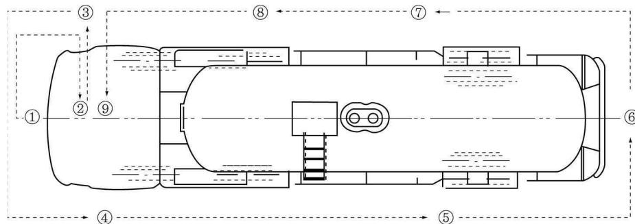
그림 3.2.2.1.1(1) 차량의 점검 위치 및 점검 순서
