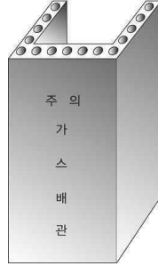
그림 2.5.7.3.1(2)③ “ㄷ” 형태의 철근콘크리트재 방호구조물에 의한 방호조치
