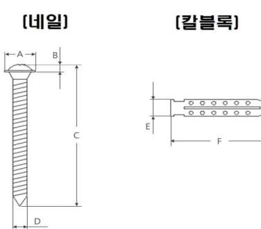
그림 2.5.10.3.2(5-3) 네일형 라인마크의 모양 · 크기 및 표시 방법
