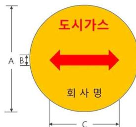
그림 2.5.10.3.2(5-2) 스티커형 라인마크의 모양·크기 및 표시 방법
