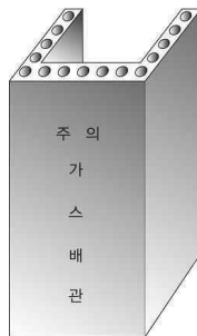
그림 2.5.7.6.11(2)③ “ㄷ” 형태의 철근콘크리트제 방호구조물에 의한 방호조치
