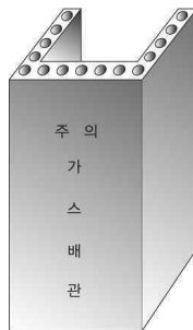
그림 2.5.7.6.11(2)③ “ㄷ” 형태의 철근콘크리트제 방호구조물에 의한 방호조치
