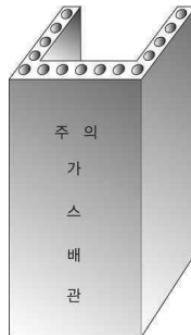
그림 2.5.7.6.9(2)③ “ㄷ” 형태의 철근콘크리트제 방호구조물에 의한 방호조치
