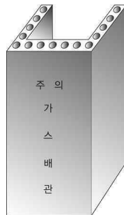
그림 2.5.7.6.9(2)③ “ㄷ” 형태의 철근콘크리트제 방호구조물에 의한 방호조치
