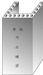
그림 2.5.7.6.9(2)③ “ㄷ” 형태의 철근콘크리트제 방호구조물에 의한 방호조치
