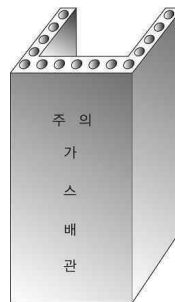
그림 2.5.7.6.9(2)③ “ㄷ” 형태의 철근콘크리트제 방호구조물에 의한 방호조치
