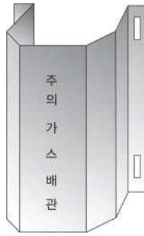
그림 2.5.7.3.2(1) 방호철판을 사용한 방호구조물 예시
