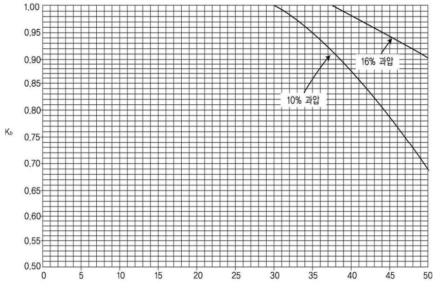
$$\text{게이지 배압(\%)} = \frac{\text{배압(kPa(g))}}{\text{설정압력(kPa(g))}} \times 100$$
