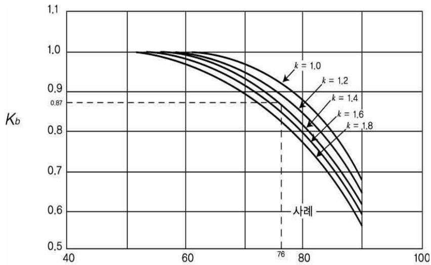
$$\text{게이지 배압(\%)} = \frac{\text{배압(kPa(g))}}{\text{설정압력(kPa(g))}} \times 100$$
