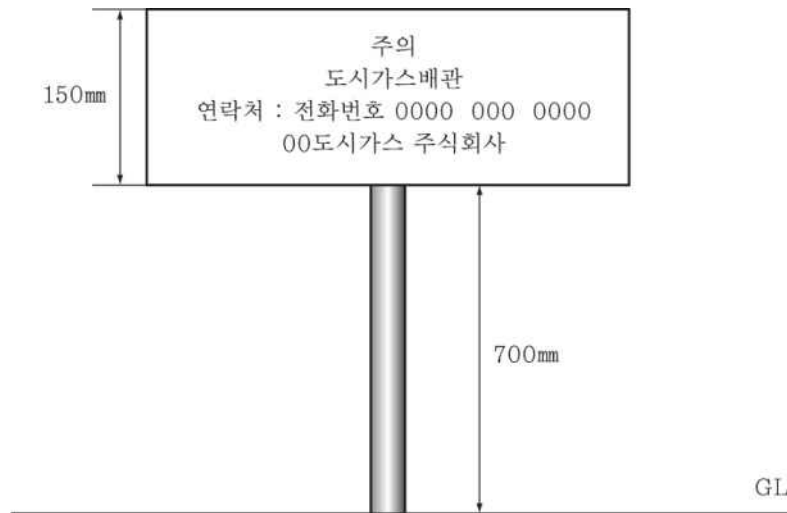
그림 2.10.3.3.4(3) 표지판의 치수 및 표기방법의 예
