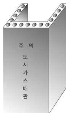
그림 2.5.8.3.1(4)③ “C” 형태의 철근콘크리트재 방호구조물
