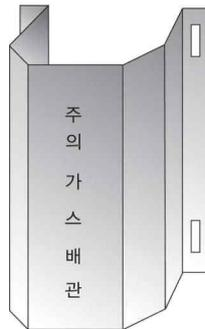
그림 2.5.8.3.2(1) 방호철판을 사용한 방호구조물 예시
