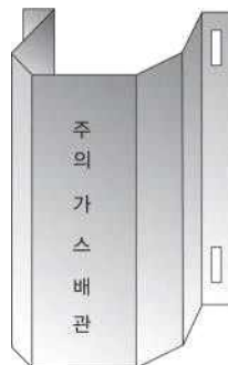
그림 2.5.8.3.2(1) 방호철판을 사용한 방호구조물 예시
