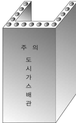
그림 2.5.7.3.3③ 철근콘크리트 방호조치
