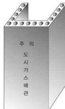
그림 2.5.4.3.3③ “ㄷ” 형태의 철근콘크리트재 방호구조물
