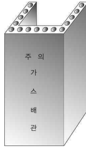
그림 2.5.7.6.11(2)③ “ㄷ” 형태의 철근콘크리트제 방호구조물에 의한 방호조치
