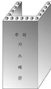
그림 2.5.7.6.9(2)③ “ㄷ” 형태의 철근콘크리트제 방호구조물에 의한 방호조치
