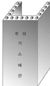
그림 2.5.7.6.9(2)③ “ㄷ” 형태의 철근콘크리트제 방호구조물에 의한 방호조치
