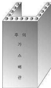
그림 2.5.7.6.9(2)③ “ㄷ” 형태의 철근콘크리트제 방호구조물에 의한 방호조치
