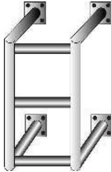
그림 2.5.7.6.9(2)② “ㄷ” 형태로 가공한 강관제 구조물에 의한 방호조치
