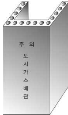
그림 2.5.8.3.1(4)③ “ㄷ” 형태의 철근콘크리트재 방호구조물
