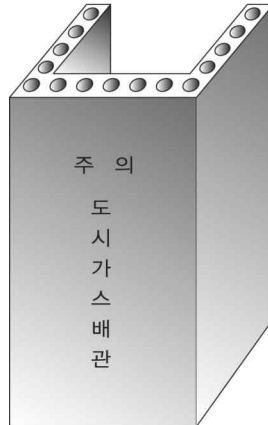
그림 2.5.8.3.3③ 철근콘크리트 방호조치
