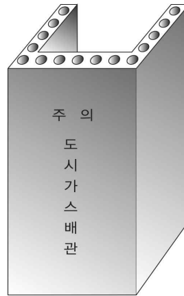
그림 2.5.8.3.3③ 철근콘크리트 방호조치
