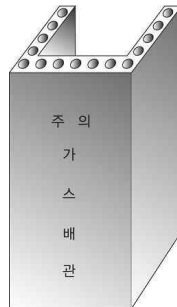
그림 2.5.8.3.1(4)③ “ㄷ” 형태의 철근콘크리트재 방호구조물
