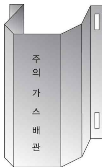
그림 2.5.8.3.2(1) 방호철판을 사용한 방호구조물 예시
