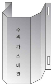
그림 2.5.8.3.2(1) 방호철판을 사용한 방호구조물 예시
