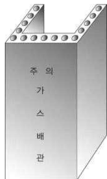
그림 2.5.8.3.2(3) 철근콘크리트재 방호구조물 예시
