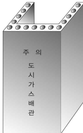
그림 2.5.7.3.3③ 철근콘크리트 방호조치
