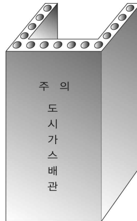
그림 2.5.7.3.3③ 철근콘크리트 방호조치
