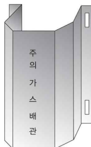
그림 2.5.7.3.2(1) 방호철판을 사용한 방호구조물 예시
