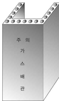
그림 2.5.7.3.2(3) 철근콘크리트제 방호구조물 예시
