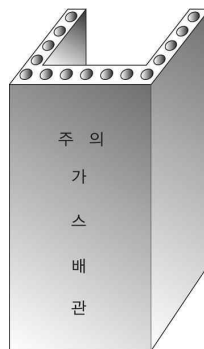
그림 2.5.7.3.2(3) 철근콘크리트제 방호구조물 예시
