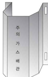
그림 2.5.7.3.2(1) 방호철판을 사용한 방호구조물 예시
