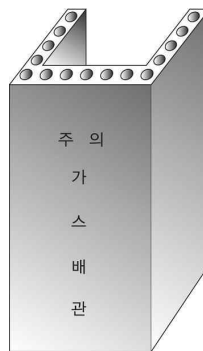
그림 2.5.7.3.2(3) 철근콘크리트재 방호구조물 예시
