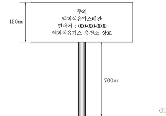
그림 2.5.10.2.6(4) 표지판의 치수 및 표기방법의 예시
