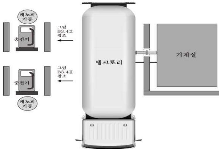
그림 B3.4② 보호대 설치 평면도 예시
