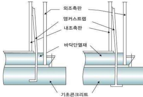
그림 2.2.3.7 평저원통형 저장탱크의 앵커스트랩 설치방법
