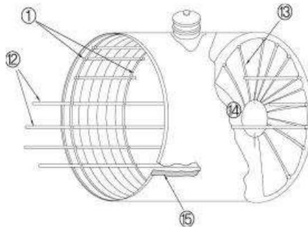
그림 2.3.3.5.1① 폭발방지장치 설치의 예시
