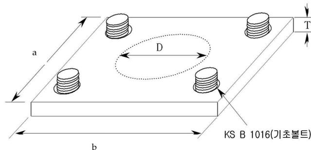
그림 2.4.4.2.2(4-2) 강관제 보호대의 받침대 설치 방법 &lt;개정 19.8.14&gt;
