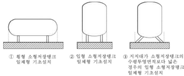
그림 2.3.3.2.3(4) 소형저장탱크 일체형기초 설치방법 예시
