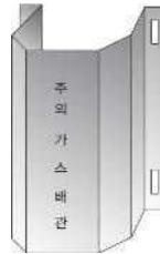
그림 2.5.7.3.2(1) 방호철판을 사용한 방호구조물 예시
