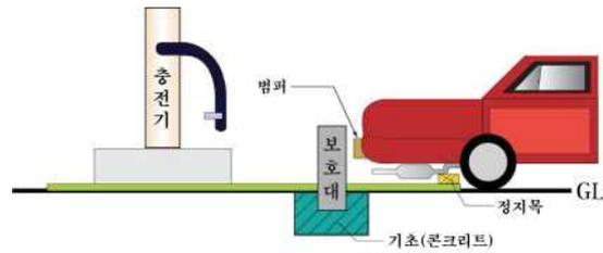
그림 2.4.4.2.2(6) 보호대 설치방법 예시
