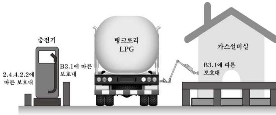
그림 B3.4① 보호대 설치 단면도 예시
