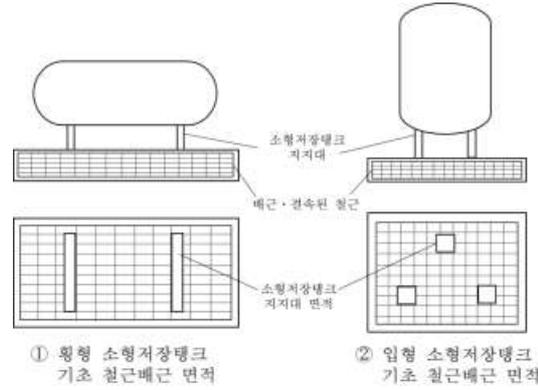
그림 2.3.3.2.3(3-3) 소형저장탱크 일체형 철근콘크리트 기초의 철근배근 예시
