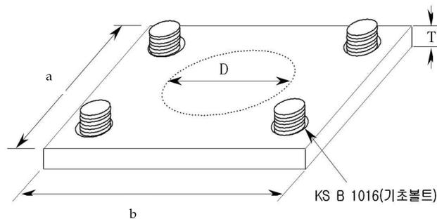
그림 23323(6-4-2) 강관제 보호대의 받침대 설치 방법 <개정 198.14>
