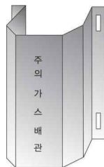
그림 2.5.7.3.2(1) 방호철판을 사용한 방호구조물 예시
