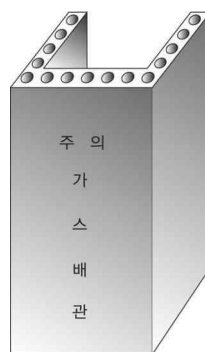
그림 2.5.7.3.2(3) 철근콘크리트재 방호구조물 예시
