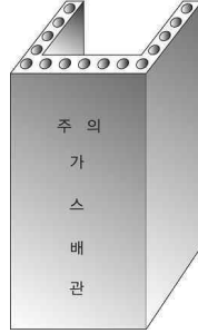
그림 2.5.7.3.1(2)③ “ㄷ” 형태의 철근콘크리트재 방호구조물에 의한 방호조치
