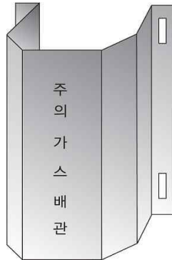
그림 2.5.7.3.1(2)① “ㄷ” 형태로 가공한 철판제 방호구조물에 의한 방호조치
