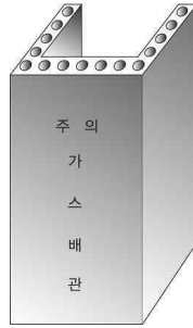
그림 2.5.7.3.1(2)③ “ㄷ” 형태의 철근콘크리트재 방호구조물에 의한 방호조치
