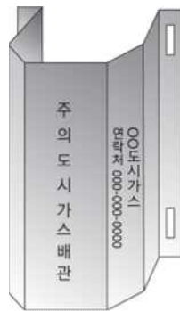
그림 2.5.4.3.3① “ㄷ” 형태로 가공한 방호철판에 의한 방호구조물
