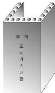
그림 2.5.4.3.3③ “ㄷ” 형태의 철근콘크리트제 방호구조물
