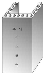
그림 2.5.7.6.11(2)③ “ㄷ” 형태의 철근콘크리트제 방호구조물에 의한 방호조치
