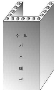
그림 2.5.7.6.11(2)③ “ㄷ” 형태의 철근콘크리트제 방호구조물에 의한 방호조치
