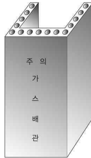
그림 2.5.7.6.9(2)③ “ㄷ” 형태의 철근콘크리트제 방호구조물에 의한 방호조치
