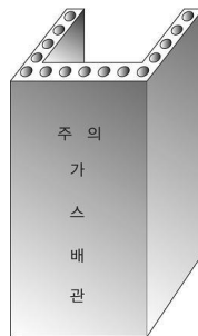
그림 2.5.7.6.9(2)③ “C” 형태의 철근콘크리트제 방호구조물에 의한 방호조치
