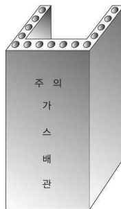
그림 2.5.7.6.9(2)③ “ㄷ” 형태의 철근콘크리트제 방호구조물에 의한 방호조치
