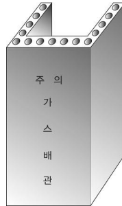
그림 2.5.7.6.9(2)③ “ㄷ”형태의 철근콘크리트제 방호구조물에 의한 방호조치
