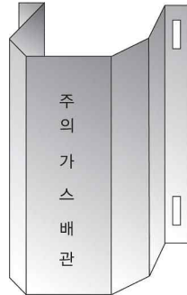
그림 2.5.7.3.2(1) 방호철판을 사용한 방호구조물 예시
