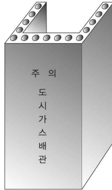
그림 2.5.8.3.1(4)③ “ㄷ” 형태의 철근콘크리트재 방호구조물
