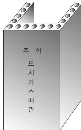
그림 2.5.8.3.3③ 철근콘크리트 방호조치
