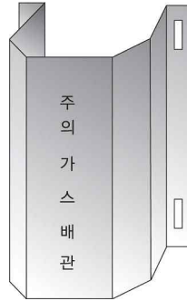
그림 2.5.8.3.2(1) 방호철판을 사용한 방호구조물 예시
