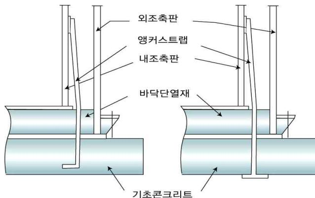
그림 2.2.3.7 평저원통형 저장탱크의 앵커스트랩 설치방법
