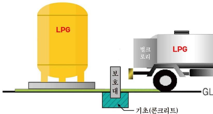
그림 2.3.3.6.3(6-7) 보호대 설치방법 예시
