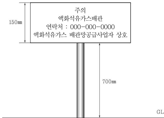
그림 2.10.1.6.2(4) 표지판의 치수 및 표기방법의 예시
