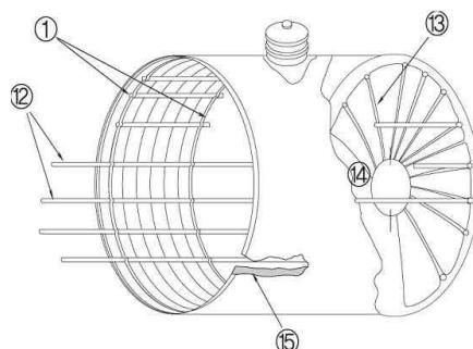
그림 2.3.3.4.1① 폭발방지장치 설치의 예시
