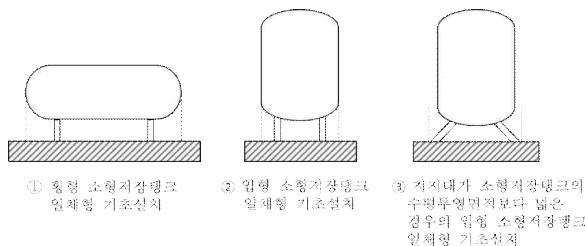
그림 2.3.3.6.3(4) 소형저장탱크 일체형기초 설치방법 예시
