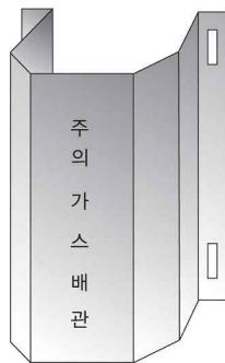
그림 2.5.8.3.2(1) 방호철판을 사용한 방호구조물 예시
