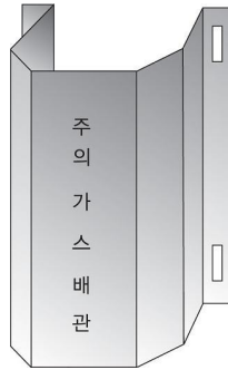
그림 2.5.8.3.2(1) 방호철판을 사용한 방호구조물 예시
